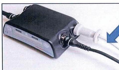
Обвивка на кабелот за напојување
