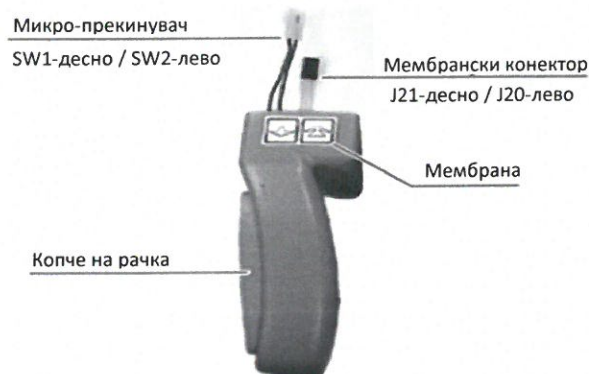
Слика 1 Микро-прекинувач и мембрански конектори на рачката
